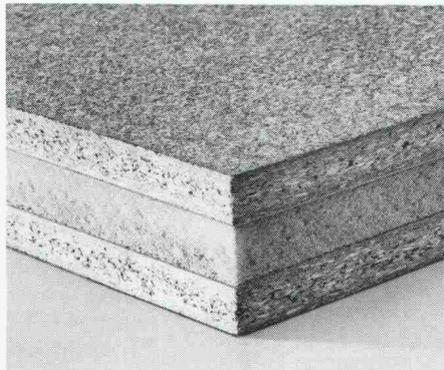
HOMISOL DUO Elemente bestehen aus zwei formaldehydfrei gebundenen Spanplatten und einer druckfesten Kernisolation aus Polyurethan. Sie sind tauchgrundfest hergestellt und lassen sich beliebig beschichten, furnieren oder streichen. Die steglose Verbindung garantiert einen durchgehend gleichmässigen k-Wert. Verlangen Sie ausführliche Unterlagen über Elemente und Befestigungstechnik. Rufen Sie uns an.
