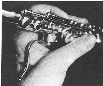
Bild 2. Demontable Stütze für Querflöte auf der linken Hand, Dr. F. Findeisen, Deutschland
