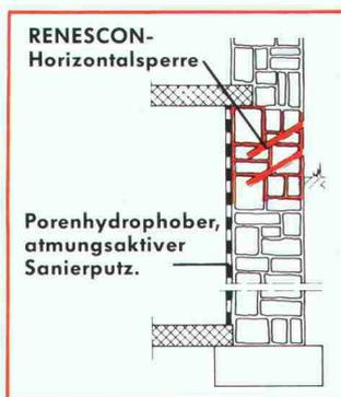
den Mauerwerken ein für allemal. Renescan-Injektionen bilden eine Horizontalsperre. Die Nässe steigt nicht mehr auf und das Mauerwerk kann austrocknen.
