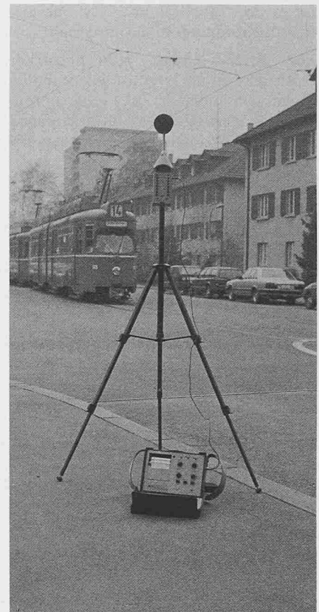
Bild 2. Modernes Lärmmessgerät mit Pegelschreiber zur Aufzeichnung des zeitlichen Lärmverlaufes
