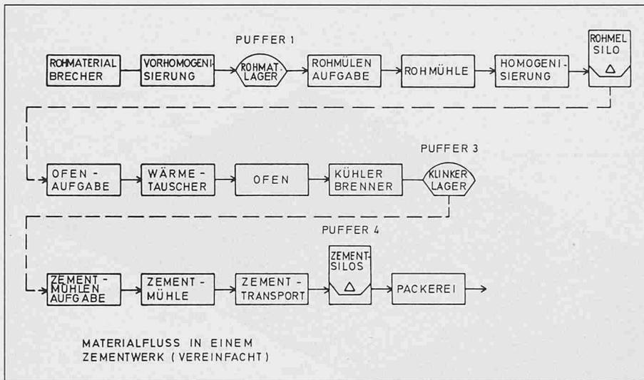
Bild 3. Schematische Darstellung des Materialflusses in einem Zementwerk. Die vier Puffer ermöglichen eine wirkungsvolle Entkopplung der wesentlichen Produktionsabschnitte. Die Empfindlichkeit des Systems auf Störungen und Wartungsunterbrüche ist damit wesentlich reduziert
