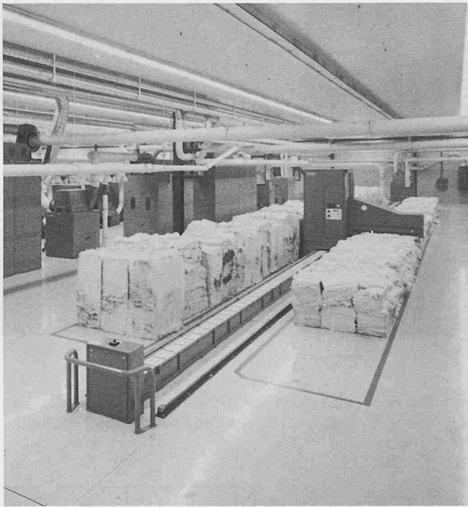
Bild 2. Die automatische Ballenabtragmaschine «Unifloc» bildet kleine Faserflocken und fördert sie pneumatisch in die Putzerei
