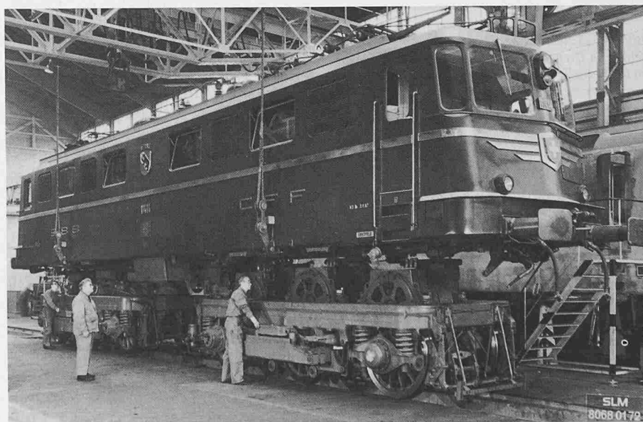
Bild 15. Lokomotive Ae 6/6 Nr. 11414 der SBB, umgebaut für Schnellfahrversuche bis 200 km/h in Deutschland (Foto SLM 1968)
