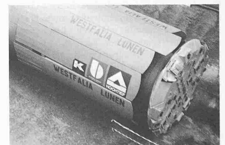
Bild 6. Vollschnittmaschine mit spreizbarem Messerschild (Erkundungsstollen Freudenstein-Ost)
