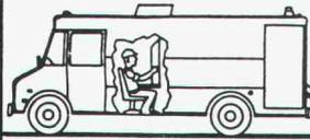
Optische und pneumatische Prüfung von Rohrleitungen. Dichten von Muffen, Rissen und Wurzeleinwüchsen, ohne zu graben.
