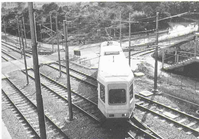
Bild 8. Gleisentwicklung im Bereich einer stark befahrenen Abzweigung mit Parallelgleis
