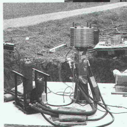
Schwingungserregung einer Fundamentplatte.
