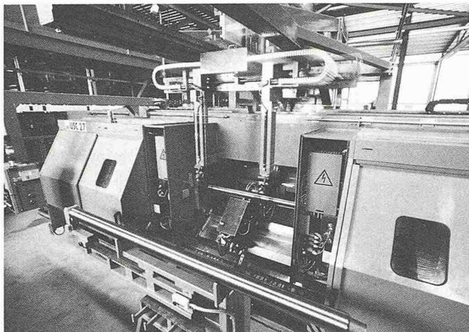
Bild 1. Teilesfamilie Walzen: Ansicht der CNC-gesteuerten Drehmaschine EMAG mit Be- und Entladeroboter
