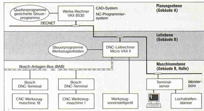
Bild 8. DNC-System Teilefamilie Nocken des Sulzer Projekts PK 90
