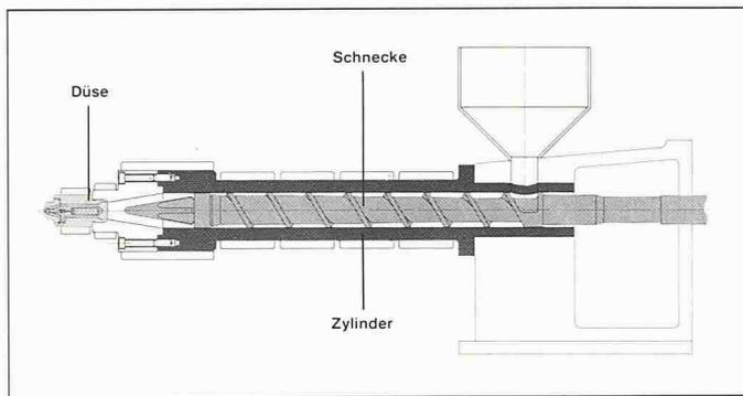
Bild 1. Prinzipschema einer Spritzgussmaschine mit Zylinder, Schnecke, Düse, Einfüll- und Antriebsvorrichtung
