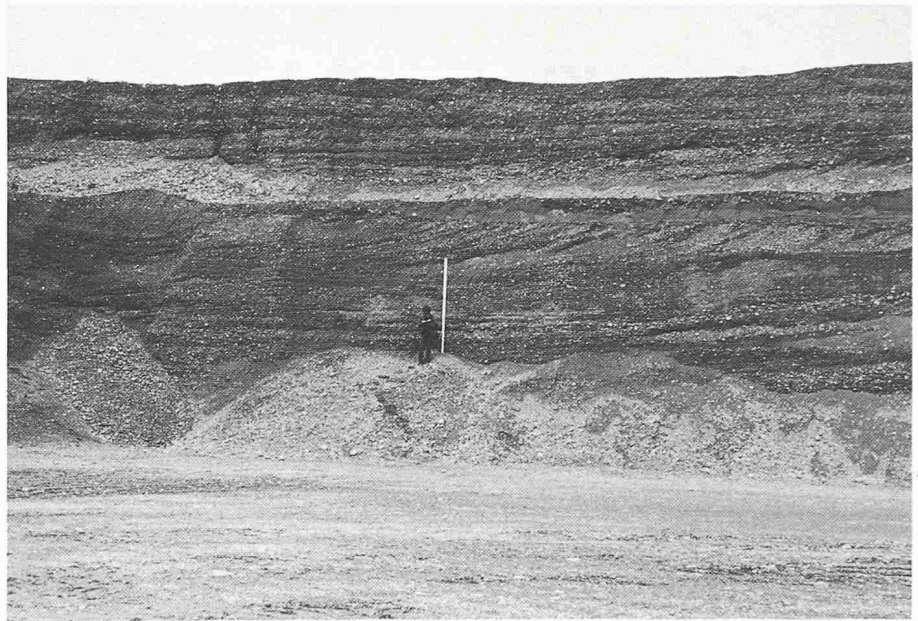
Bild 2. An der Wand einer Kiesgrube werden die Inhomogenitäten der Grundwasserträger aufgeschlossen (Foto P. Huggenberger)
