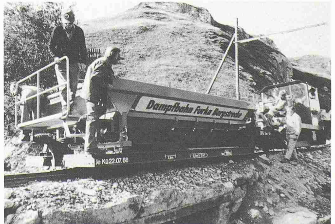
Mit dem Eigenbau-Tiefladewagen und Wechselbehälter auf erfolgreicher Probefahrt
