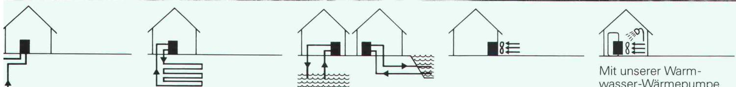
Mit vertikalen Erdsonden wird die geothermische Wärme aus dem Erdinnern genutzt. Die bis zu 120 m tiefen Sonden profitieren von der konstanten Erdtemperatur von 8-10°C.
