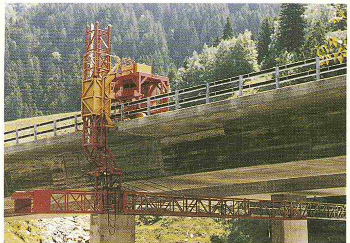
Bild 3. Untersichtsgesetz «Moog» Typ MBS 200 im Einsatz Bildautor: A. von Glutz
