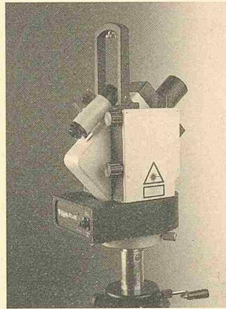
Mit einem Handgriff kann der Theoplane in einen Rotationsla-ser verwandelt werden, indem der Rotationskopf aufgesetzt wird. Damit erzeugt er eine Laserebene in horizontaler, ver-tikaler oder beliebig geneigter Lage.
