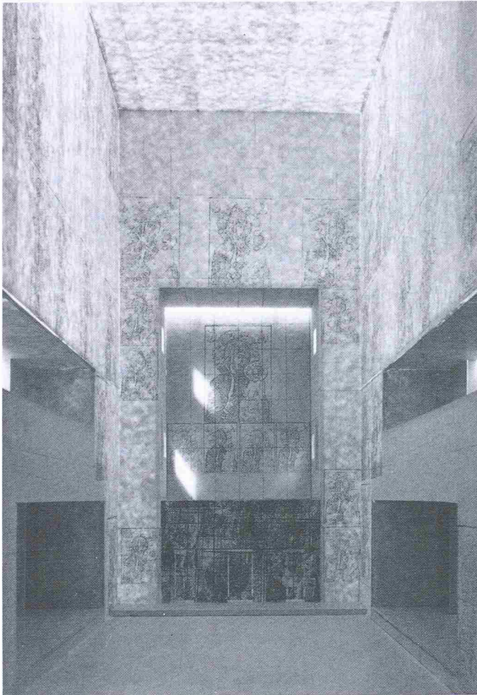
Die Lichtintensität im Innenraum wird reguliert durch die äussere Hülle der Kirchenfassade, die aus einem mosaikähnlichen Gitterwerk von transparenten und nicht transparenten Platten besteht, welche mehr oder weniger Licht auf die inneren Marmorplatten werfen.
