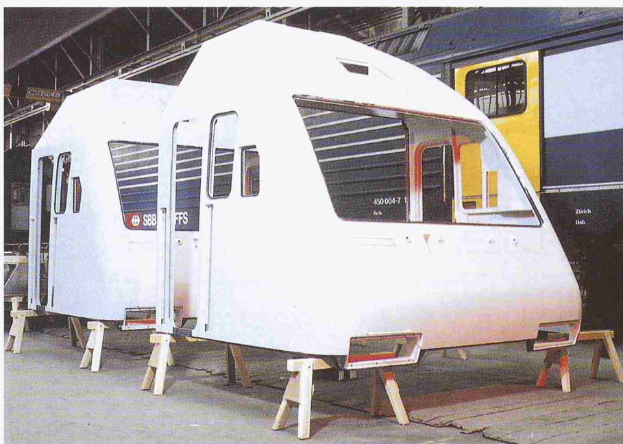
Bild 3. Lok 2000: Führerkabinen, bereit für den Zusammenbau mit dem Kasten
