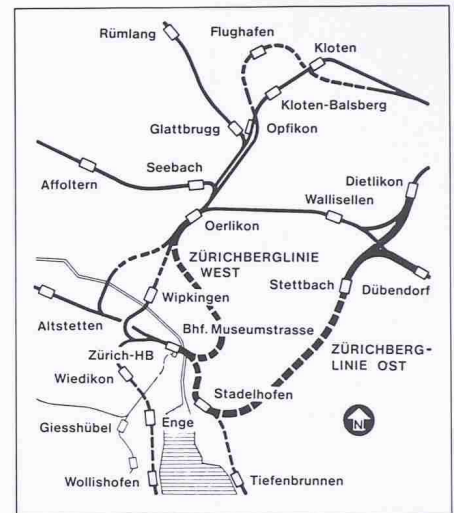
Bild 4. Zürichbergtunnel, Varianten Ost (offiziell) und West
