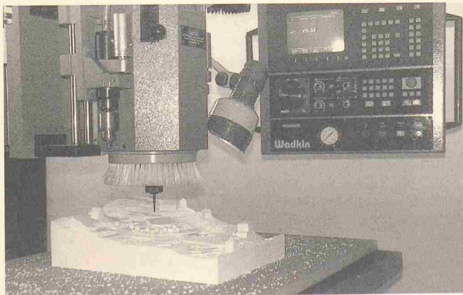
Modellerstellung durch NC-gesteuerte Fräsmaschine ab mittels CAD erstellter Zeichnung
