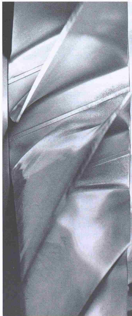
Bild 2b. Der Vergleich mit Verschmutzungsspuren lässt die Lage des Verdichtungsstosses auf der konvexen Profilsaugseite erkennen.
