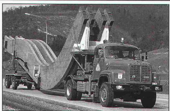
Unser Spezialfahrzeug, beladen mit den Hauptbogenträgern, unterwegs nach Neuchâtel. Der Transport von Holzkonstruktionen ist auch über weite Strecken wirtschaftlich.
