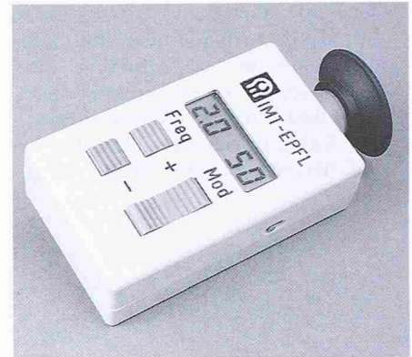
Visueller Stimulator zur Bestimmung der Flickergrenze des menschlichen Auges, der am IMT im Rahmen von Studentenprojekten entwickelt wurde
