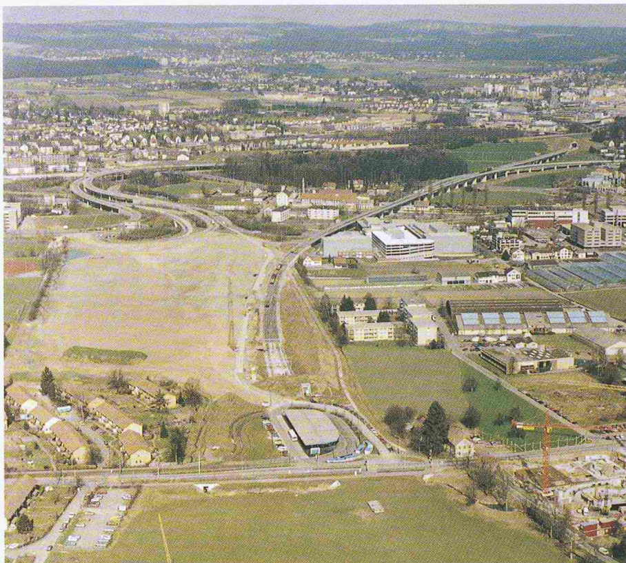
Bild 2. Nach dem Bau der S-Bahn (1990); Vordergrund: Landwirtschaftlich rekultiviertes Krumpünt, Station Stettbach, Bildmitte: Mit Tunnelausbruchmaterial gestaltete Stettbacherwiesen (Erholungsflächen, Lärmschutzhügel), gegen Hintergrund: S-Bahnviadukt Neugut und Tunnelportal Föhrlibuck (Aufnahmen: Militärflugdienst Dübendorf)
