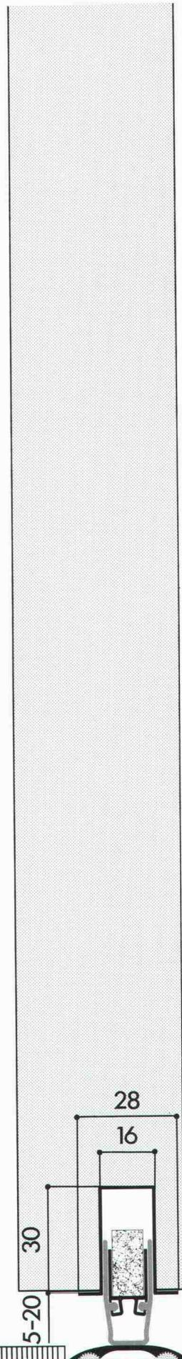
Die Hohlflachschiene F von Planet wird überall dort geklebt, wo Bodenbeläge verschiedener Beschaffenheit und Oberflächenstruktur zusammentreffen. Sie verhindert so Schallbrücken,
