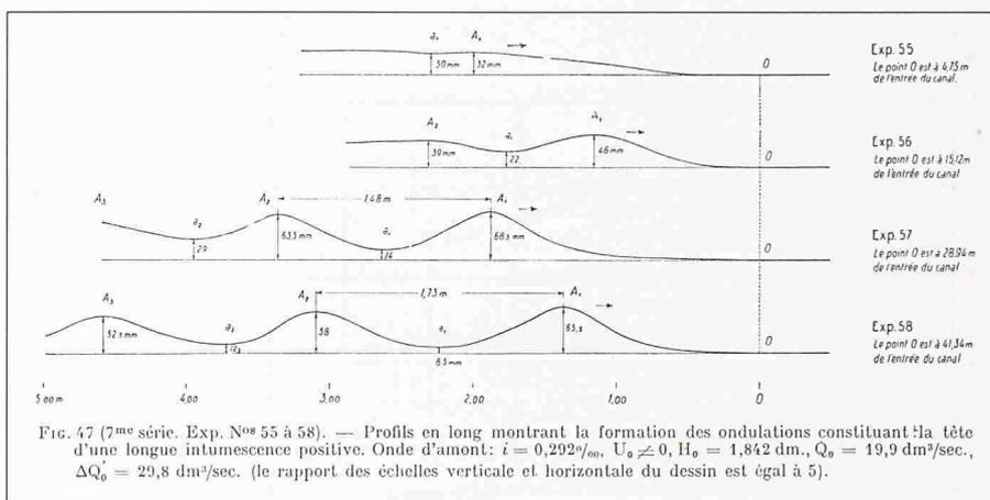
Bild 3. Längenprofile der positiven Schwallwelle, 7. Serie (Favre, 1935a)
