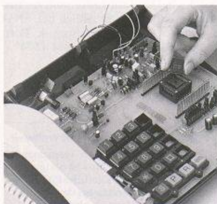
Der kombinierte Analog/Digital-Chip, in dem alle normalen Funktionen eines Telefonapparates integriert sind, beansprucht nur wenig Platz (Bild: AEG)
