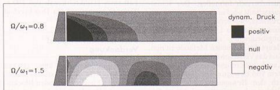
Bild 5. Dynamischer Druck bei verschiedenen Frequenzverhältnissen.
