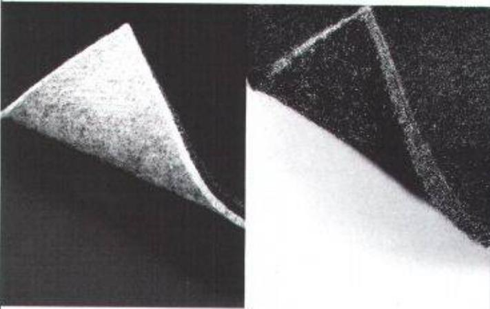
**TERRAFIX<sup>®</sup>** ist ein hochwertiger, dreidimensional wirkender Vliesstoff aus vernadelten Kunststofffasern, der für Filteraufgaben im Wasserbau eingesetzt wird.
