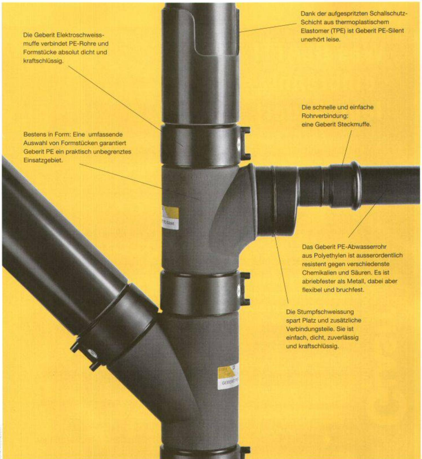
Die Geberit Elektroschweissmuffe verbindet PE-Rohre und Formstücke absolut dicht und kraftschlüssig.
