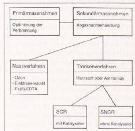
Bild 3. Möglichkeiten zur Stickoxidminderung in sauerstoffhaltigen Abgasen
