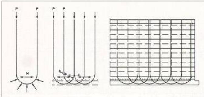
Bild 10. Vertikale Wandvorspannung mit Schlaufenverankerung
