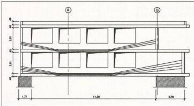
Bild 11. Wandscheibe mit Öffnungen und der entsprechenden Kabelanordnung
