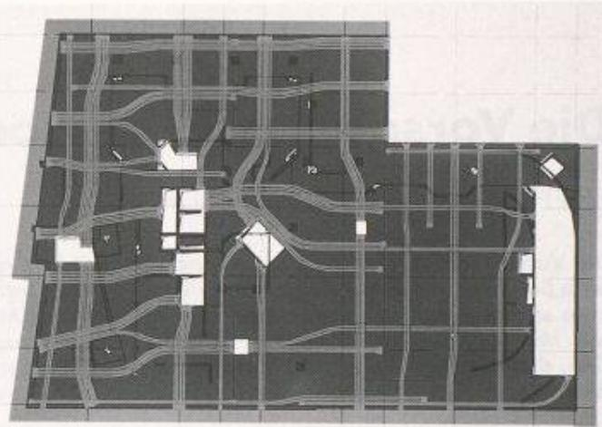
Bild 3. Anordnung der Vorspannung
