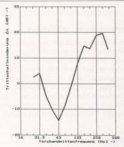
Unterlagsboden-Anordnung 4: Dämmmaterial einlagig aus 1x22 mm dicken Trittschalldämmplatten (elastifizierter Schaumkunststoff)
