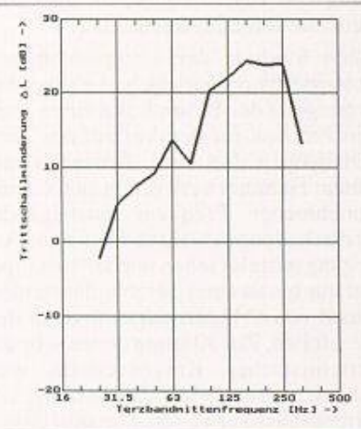
Unterlagsboden-Anordnung 5: Dämmmaterial dreilagig aus 1x20 mm und 2x15 mm dicken Trittschalldämmplatten (Glaswolle)
