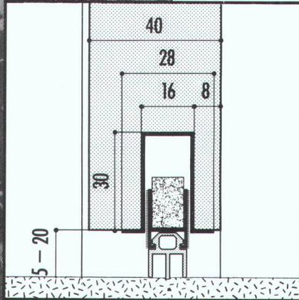
Schwellenlose Türverschlüsse von Planet schützen vor Wärmeverlust und Zugluft (Modell A3), vor Schall, Nässe und Rauch. Ausserdem werden damit Räume rollstuhlgängig. Schwellenlose Türverschlüsse von Planet können einfach in jede Tür eingebaut werden. Auch nachträglich. Anruf genügt. Wir rufen zurück.
