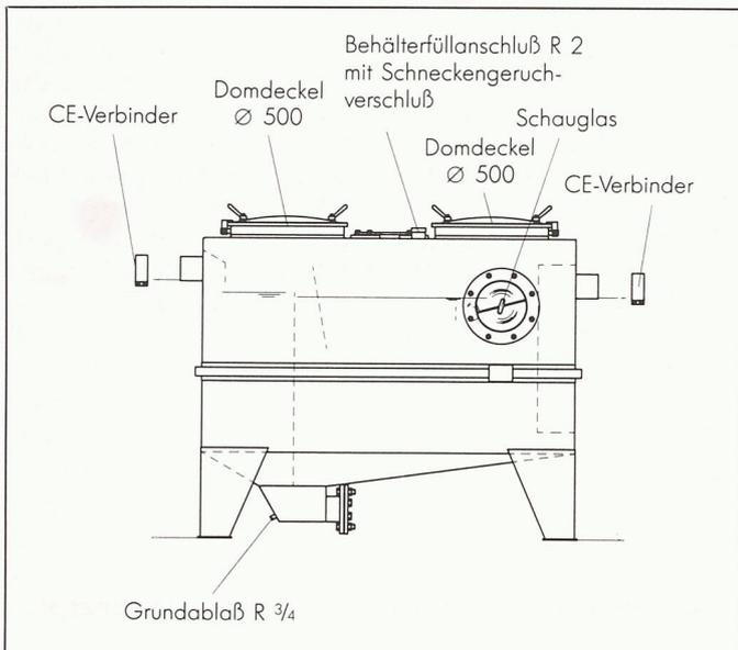
Bild 2. Fettabscheideranlage mit integriertem Ölschlammfang zur Nachrüstung einer Entleer- und Spüleinrichtung
