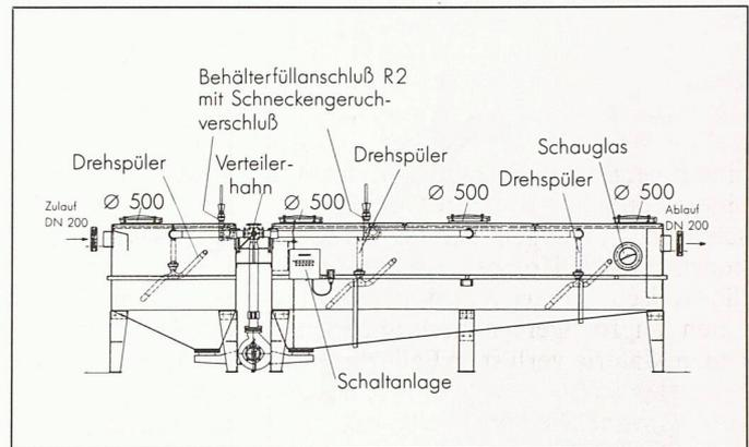
Bild 3. Fettabscheideranlage mit vorgeschaltetem Schlammfang mit Entleer- und Spüleinrichtung
