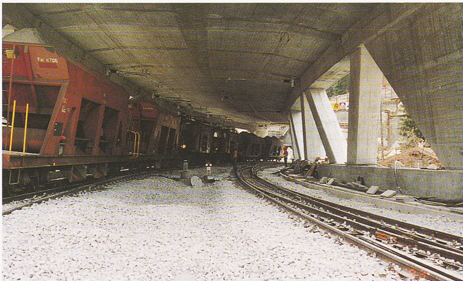
Bild 1. Belastungszug in Laststellung 2 (Foto: F. Gruber)
