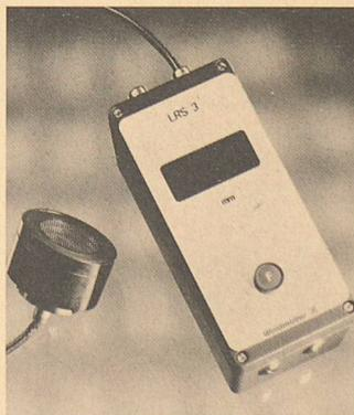
Hochauflösendes Ultraschall-Messsystem LRS 3 von Weidmüller
