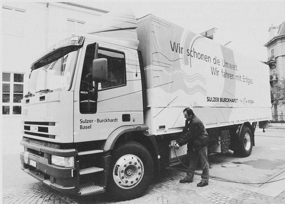
Der «EuroTech» von Sulzer-Burckhardt ist der erste ausschliesslich mit Erdgas betriebene Lastwagen der Schweiz (Bild: Comet)
