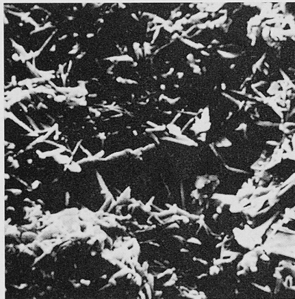
Kristalliner Gefügebau von Hebel-Porenbeton 3900fach vergrößert
