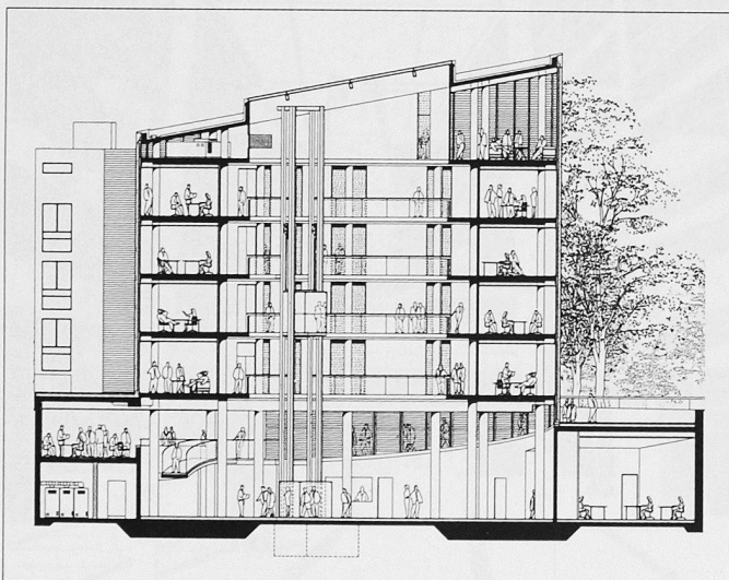
Oben: Querschnitt mit Rundhof und Liftanlage
