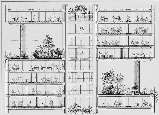
Bild 3. Schnitt mit den dreigeschossigen Einheiten. Die spiralförmige Verdrehung der Gärten ermöglicht es, den Wind für die natürliche Durchlüftung zu nutzen
