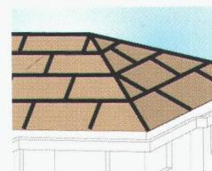
**2** Wasserdicht gemäss Norm SIA 238. Plattenstösse und Anschlüsse mit PAVATEX-Selbstklebeband 13cm abgedichtet.
