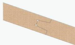
Extra entwickelte, auf das Plattenmaterial abgestimmte Steckverbindung. Für die sparrenunabhängige Verlegung.
