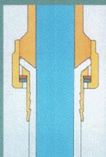
Patentierte Verbindungstechnik mit vollem Rohrquerschnitt und gleichbleibender Dichtkraft auf den Fitting.
