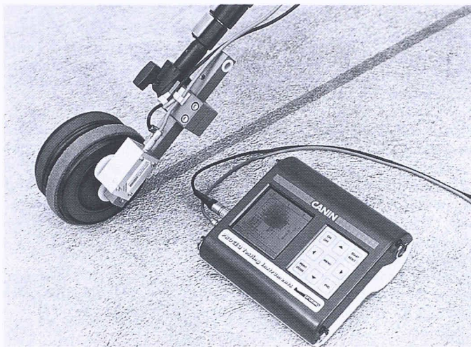
Korrosions-Messrad mit Anzeigergerät Canin
