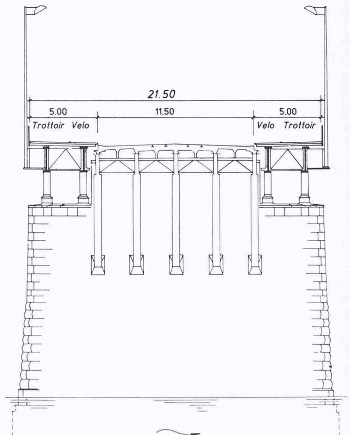
Bild 4. Querschnitt nach Verbreiterung 1939
