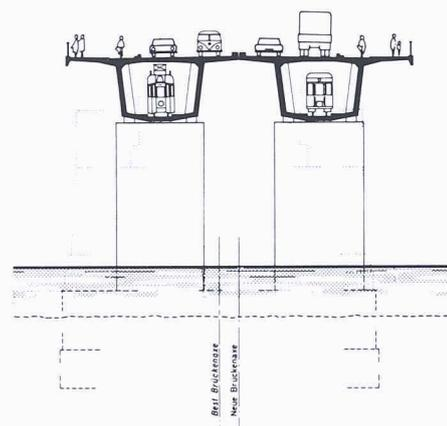
Bild 6. Doppelstöckige Brücke mit Tiefbahn (Entwurf 1968)
