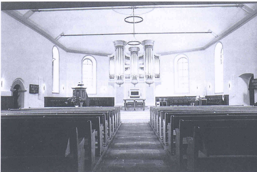
Bild 5. Evang. Kirche Nesslau. Inneres seit 1991, nach Neubau Orgel und umfassender Renovation durch das Architekturbüro H.P. Nüesch, St.Gallen (Innenisolation, neue Fenster, Fussbodenheizung). Energiekennzahl: 350 MJ/m 2 a (Durchheizbetrieb) (Bild: Hans Ulrich Scherrer, Nesslau)
