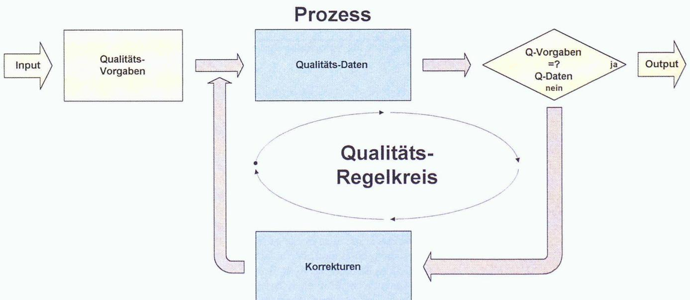
Bild 5. Elementarer Qualitäts-Regelkreis als Baustein eines Qualitätssicherungs-Systems
