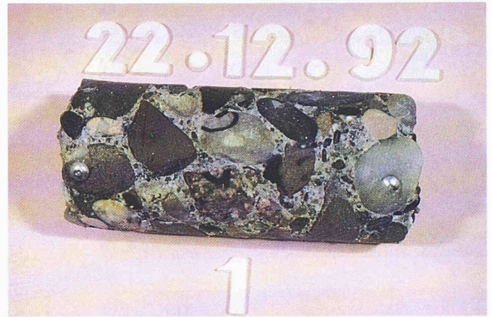
Bild 12. Betonprobekörper HOZ L-NW/HS 70% + Verflüssiger, nach 111 Wochen Sulfatlagerung mit starker Oberflächenerosion
