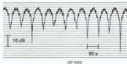
2 Schmalband-Frequenzanalyse der Immissionen. 12,3 Hz bildet die Dominante
